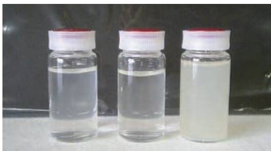
DIP製造工程の用水浄化効果 左、中は、ハリアップAC使用時 右は、ハリアップAC未使用時
