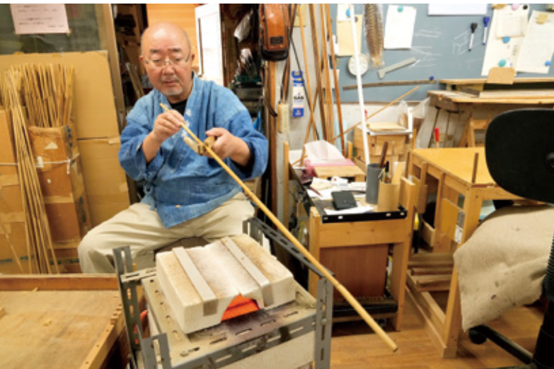
写真左、釜で熱した竹を矯め木を使い、手前から先へと竹の曲がりを矯正する。 写真右、鉄粉と松やにと油を混ぜて釣りだねをつくる。釣りだねを細長くするための板も手づくり。
