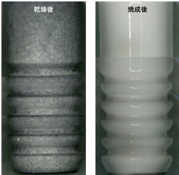
写真4 凹凸碍子へ釉薬ペーストを塗布し乾燥・焼成した様子
