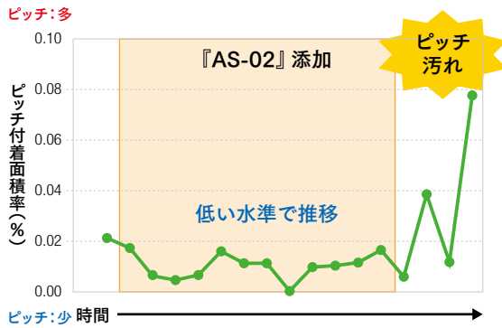
図4 実機テストにおけるピッチ付着面積率の推移 (網掛け部：『AS-02』添加期間)
