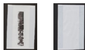
図4 フィルム印刷物のセロテープ剥離試験結果 (左：一般的な水性アクリル樹脂 右：DA-Ac)
