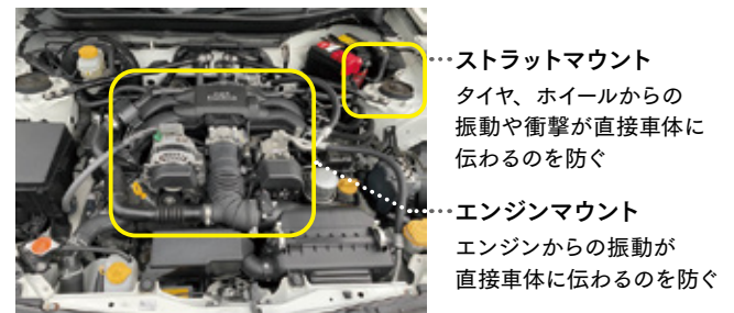
図2 実際の車に使われている防振ゴム
