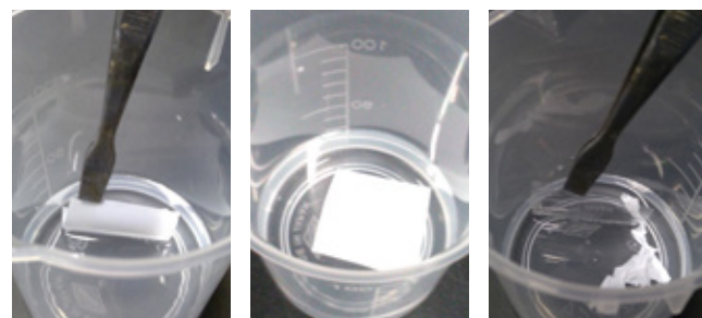
アルカリ水溶液に浸漬 プライマー層が膨潤・溶解 基材から印刷層が脱離
