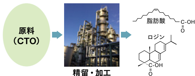
図2 精留・加工プロセスと分留物の代表構造
