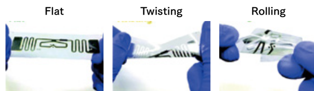
図3 フレキシブル基板（PET）へ印刷された銀ナノ粒子配線
